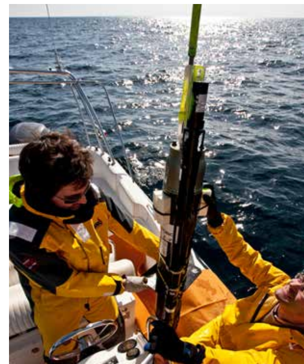
Lancement d'un flotteur ARGO. L'assimilation des données InSitu du réseau mondial ARGO est primordial pour la qualité des systèmes de Mercator Océan (voir encart page de droite). (© Immedea)
